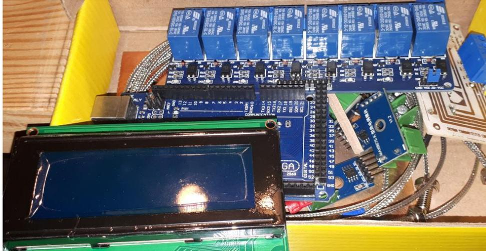
*Figura 4-13 Unidad de control y elementos electrónicos (previo a instalación)*
