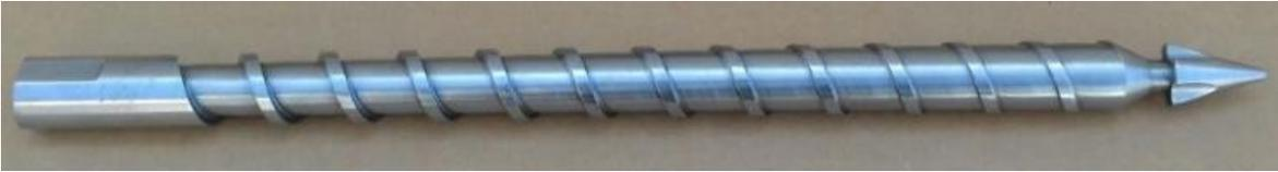
*Figura 4-8 Tornillo de extrusión*
