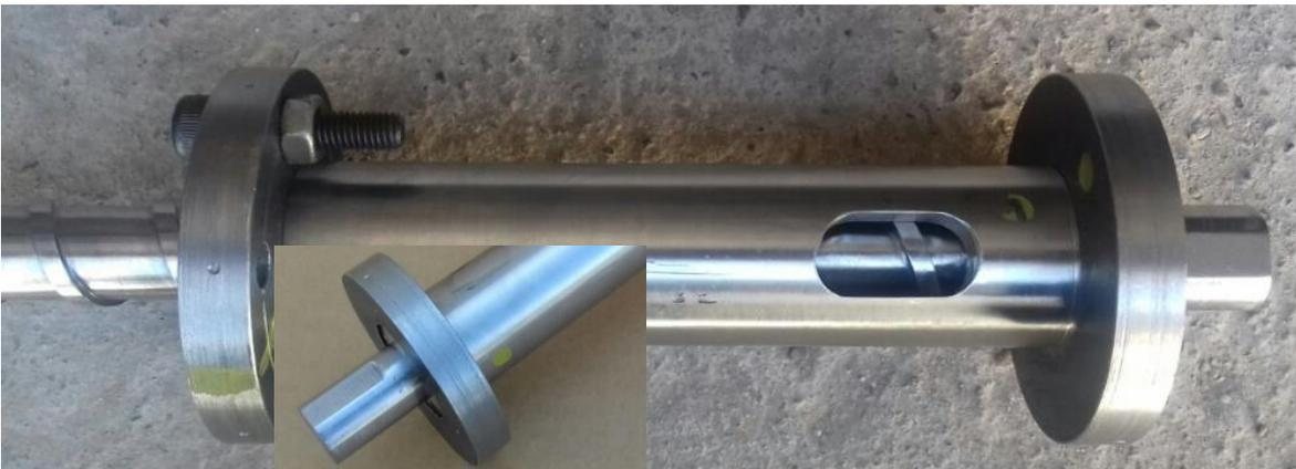
*Figura 4-10 Pruebas de movimiento de ensamble tornillo - barril*
