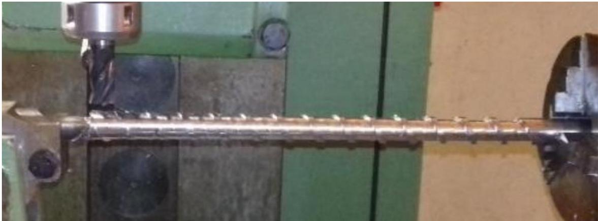
*Figura 4-9 Fabricación de tornillo extrusor, fresadora universal*
