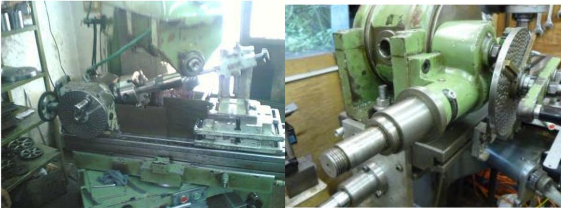
*Figura 2-11 Fresadora universal y mecanismo divisor*
